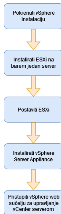
Slika 3.2 Redosljed instalacije i konfiguracije za vSphere platformu
