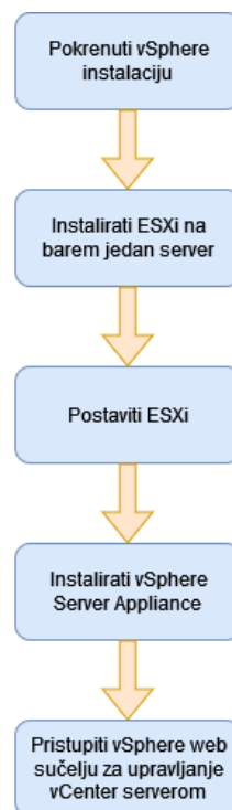
Slika 3.2 Redoslijed instalacije i konfiguracije za vSphere platformu
