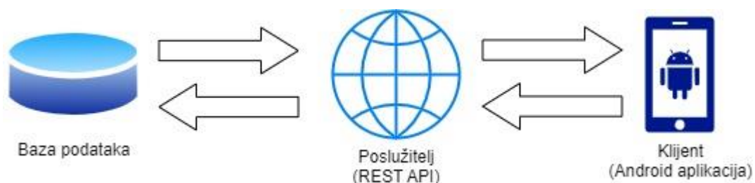
Slika 3.1 Skica arhitekture sustava
