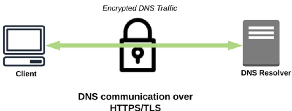
Slika 4.2 Pojednostavljeni prikaz DNS komunikacije putem HTTPS/TLS protokola (Infoblox, How to configure DoT/DoH)
