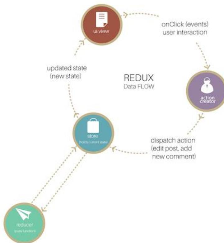
Slika 9.2. Prikaz protoka podataka unutar Redux-a
