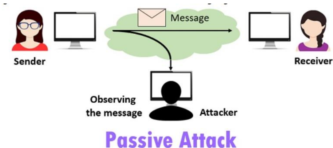
Slika 3.2 - Pasivni napad na mrežu [11]
