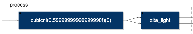
Slika 22 Povezivanje mono (jedan izlaz) efekta sa stereo efektom (dva ulaza)
