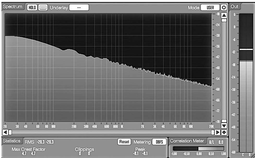
Slika 5 Spektar ružičastog šuma - ravni spektar snage
