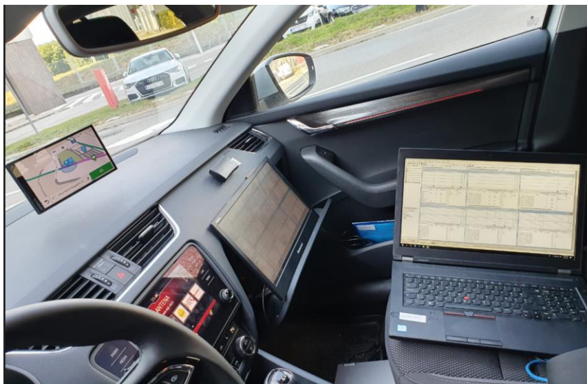
Slika 4.3.1 Instalacija mjernog sustava za drive test pomoću industrijskog računala
