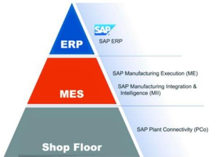
Slika 5.1 Izvršni sustav u odnosu na ERP i proizvodne procese 2
