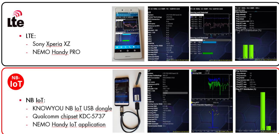
Slika 4.2 Mjerna oprema i izgled sučelja aplikacije
