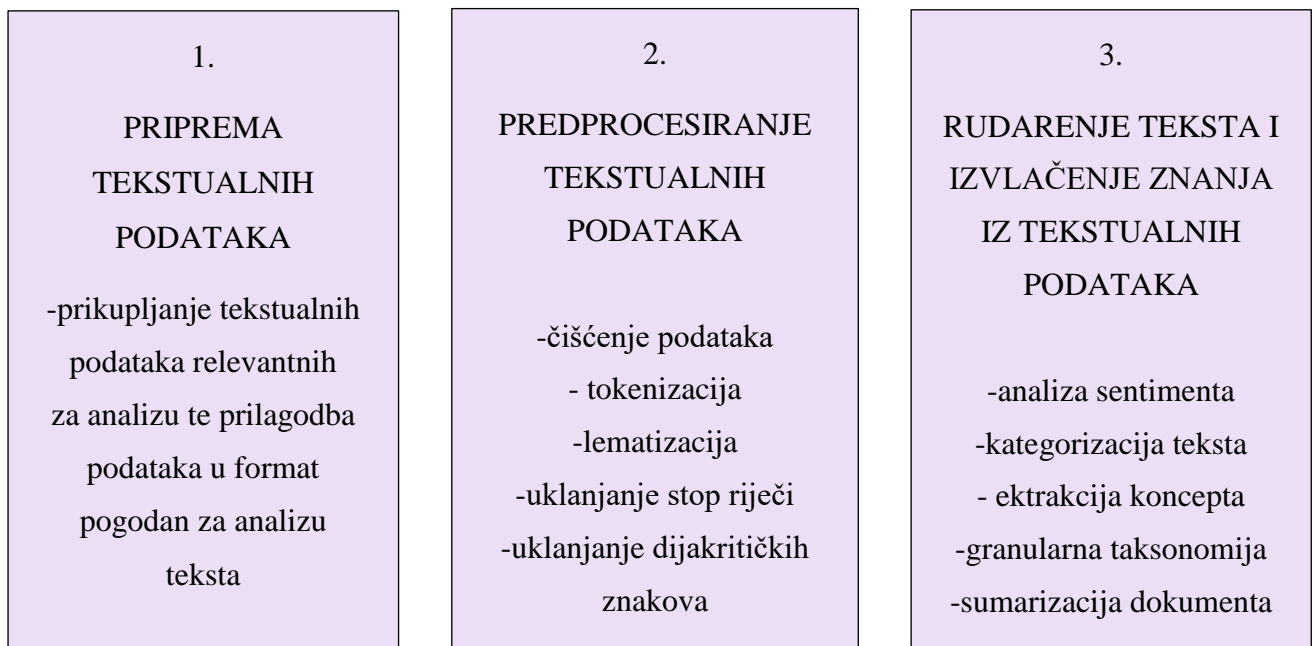
Slika 2. Faze unutar procesa rudarenja tekstualnih podataka te popis koraka koji se odnose na svaku fazu [6]
