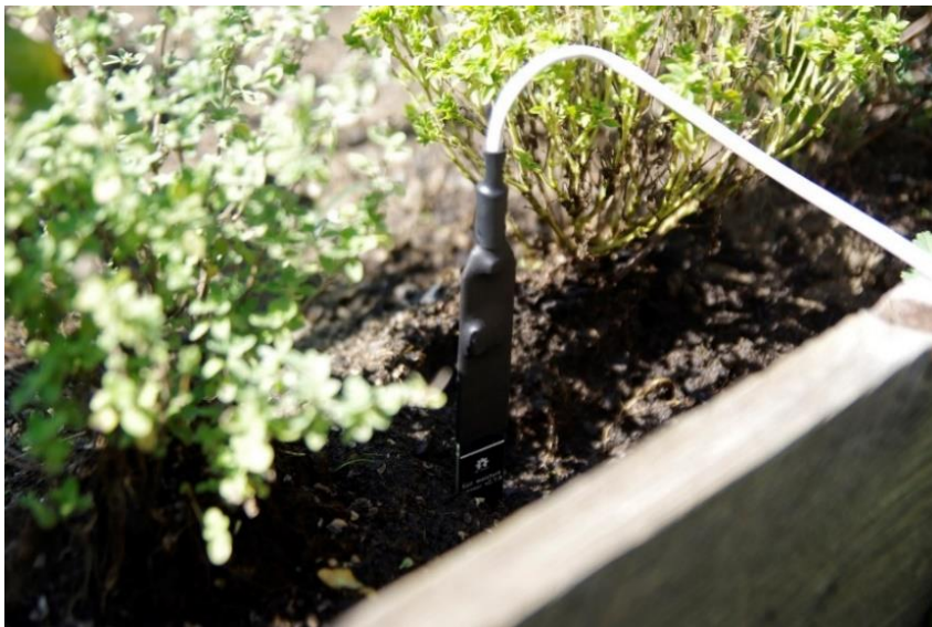
Slika 25 I2C senzor za vlagu
