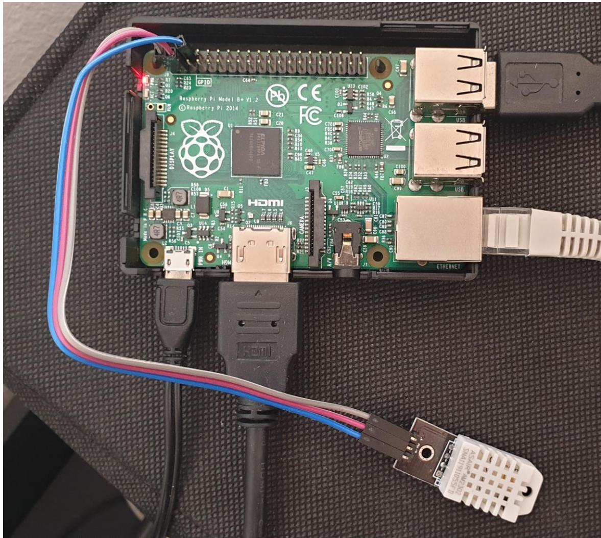
Slika 5.1 DHT22 senzor povezan na Raspberry Pi
