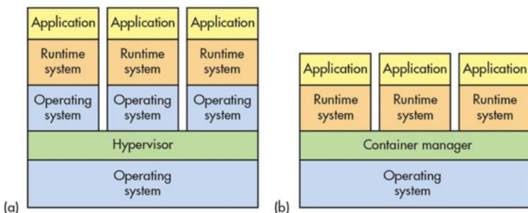
Slika 3.2 Usporedba arhitekture virtualnog stroja i kontejnera
