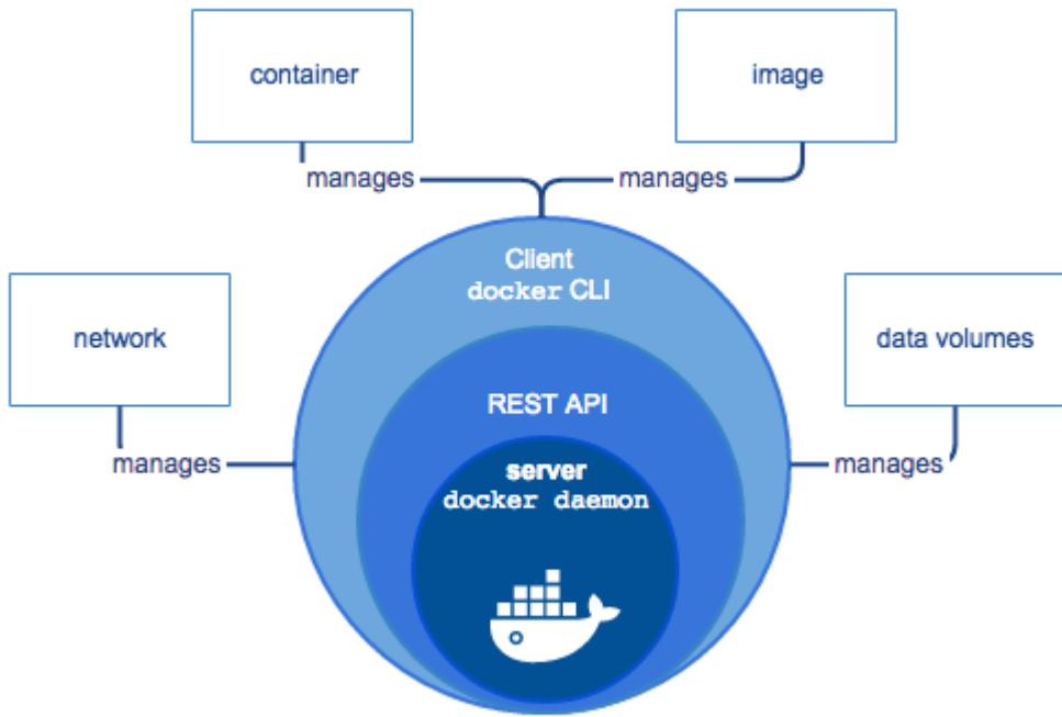
Slika 4.1 Komponente Docker Engine-a<sup>6</sup>
