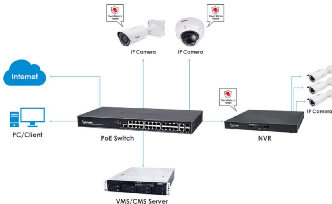
Slika 5-1 Primjer mrežnog sustava videonadzora
