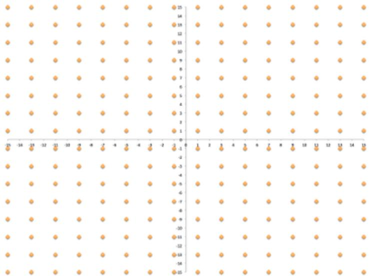
Slika 2.15 Primjer 256QAM modulacije<sup>22</sup>
