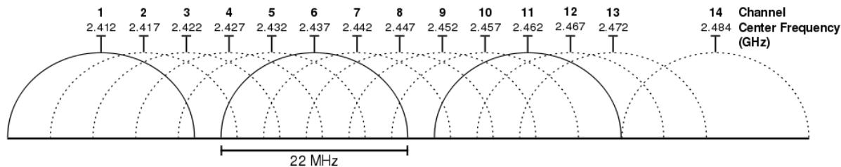
Slika 2.5 Kanali u frekvencijskom spektru 2.4 GHz<sup>9</sup>
