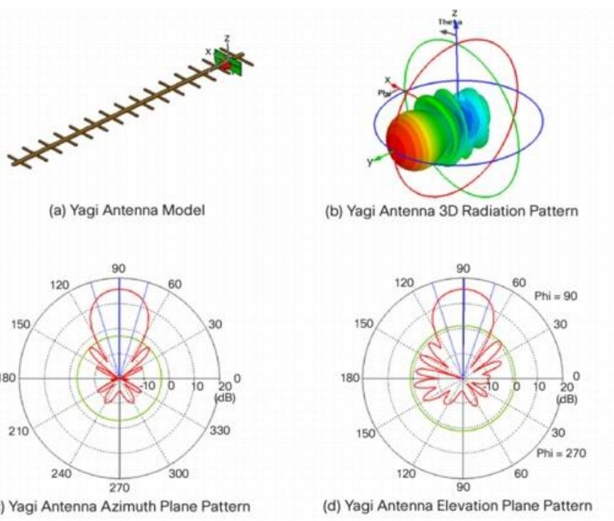
Slika 2.3 *Yagi* antena i njezini dijagrami zračenja<sup>7</sup>
