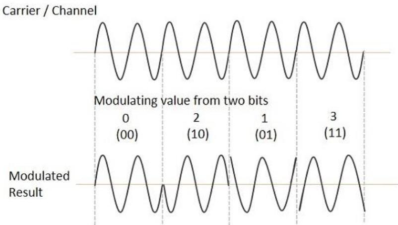
Slika 2.10 Primjer QPSK modulacije<sup>17</sup>
