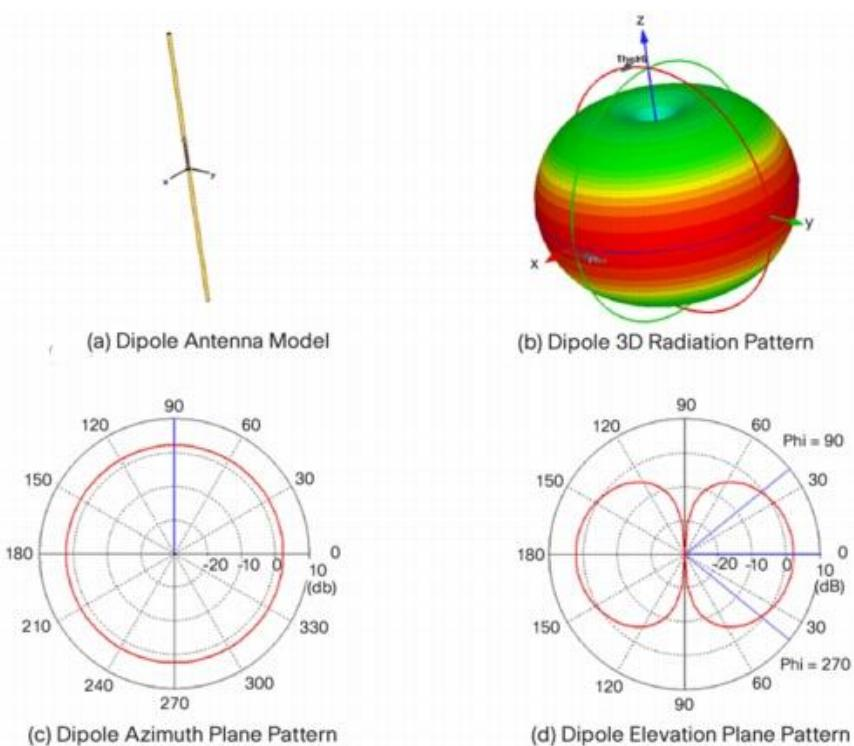
Slika 2.2 Dipol antena i njezini dijagrami zračenja<sup>6</sup>
