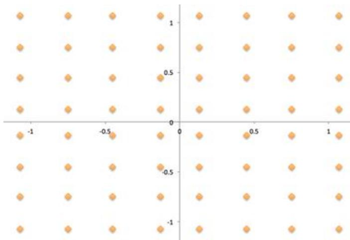
Slika 2.14 Prikaz 16QAM modulacije<sup>21</sup>
