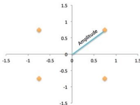
Slika 2.12 Vrijednost amplitude signala<sup>19</sup>
