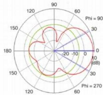
(d) Patch Antenna Elevation Plane Pattern
