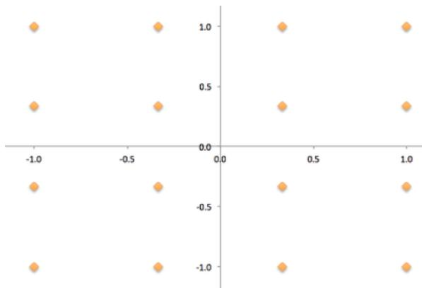
Slika 2.11 Primjer QAM modulacije<sup>18</sup>
