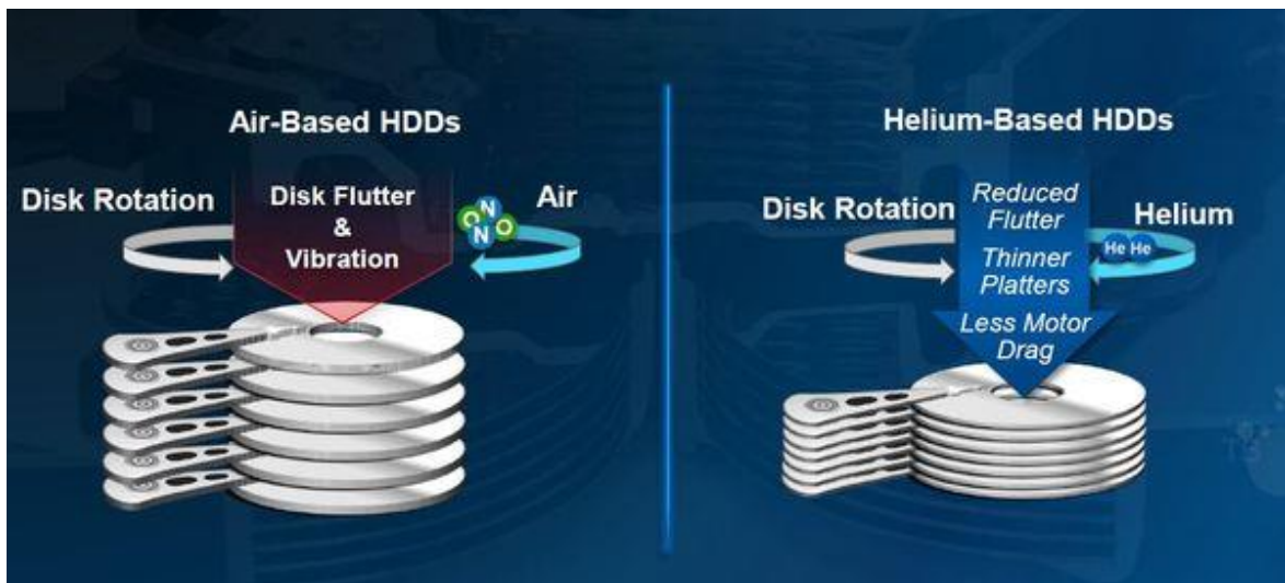
Slika 4.1. Prikaz usporedbe tvrdog diska na bazi zraka i na bazi helija, koji se koristi u Facebook-ovoj platformi za pohranu podataka Bryce Canyon. 36
