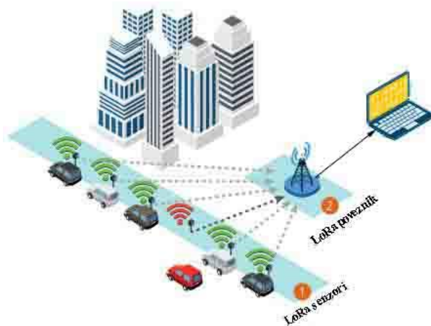
Slika 5.1 Komunikacija pametnog parkirališta korištenjem LoRaWAN tehnologije
