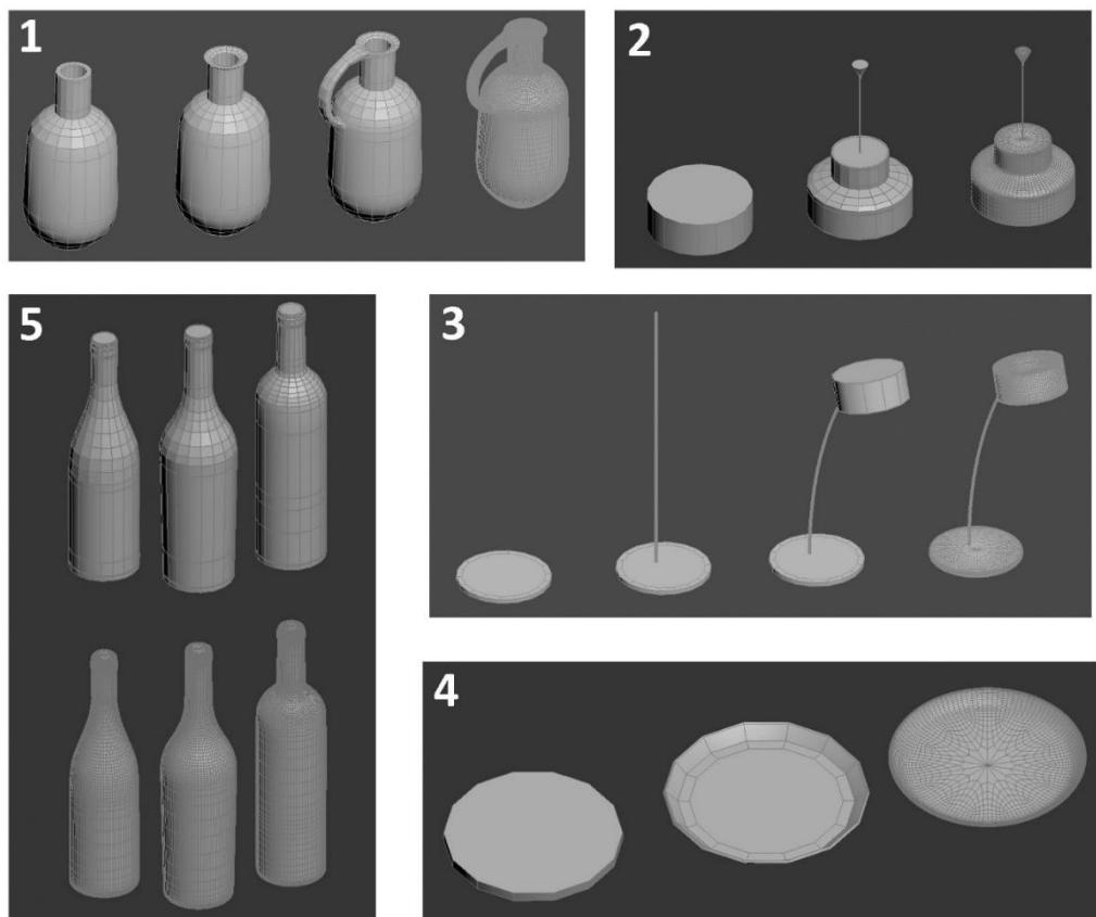
Slika 3.5 Kreiranje modela inicijalnom upotrebom objekta Cylindar
