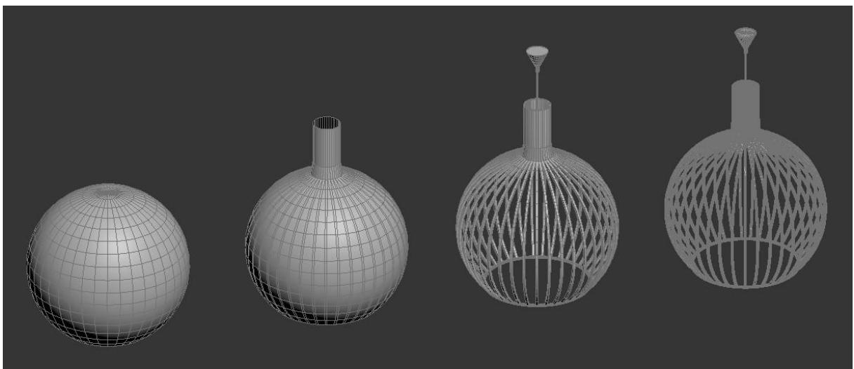
Slika 3.7 Kreiranje modela inicijalnom upotrebom objekta **Sphere**
