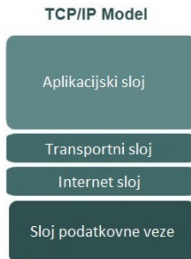
Slika 1 - Prikaz TCP/IP modela
