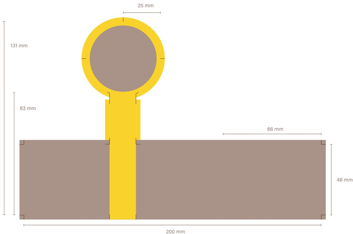
Slika 4.5 Prikaz plašta etikete s pripadajućim dimenzijama (mm)
