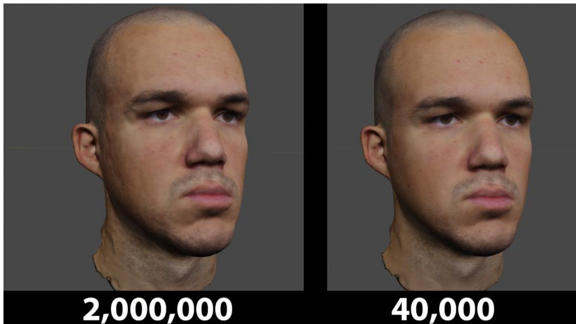
Slika 7.8 Rezultat Decimate modifikatora
