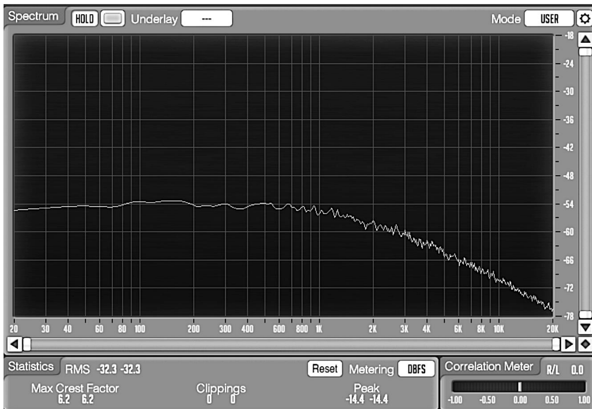
Slika 13. Bijeli šum sa redukcijom signala na 1540 Hz, 6 dB/oktavi
