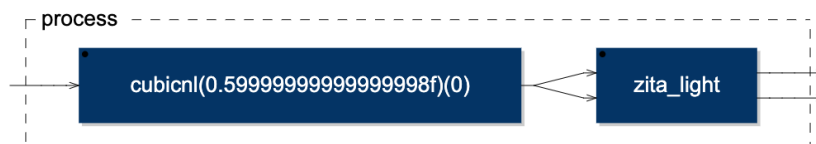
Slika 22 Povezivanje mono (jedan izlaz) efekta sa stereo efektom (dva ulaza)
