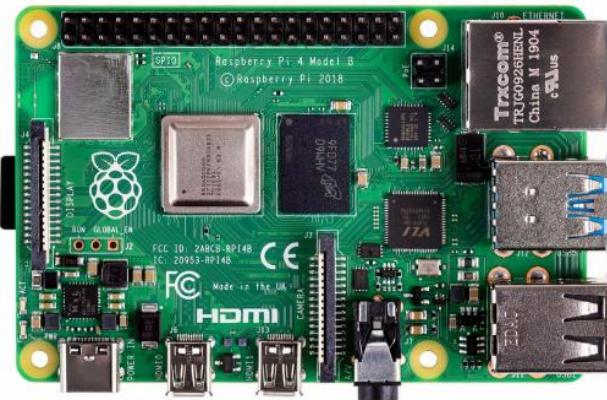
Slika 2.5. Izgled Raspberry Pi, model 4<sup>6</sup>
