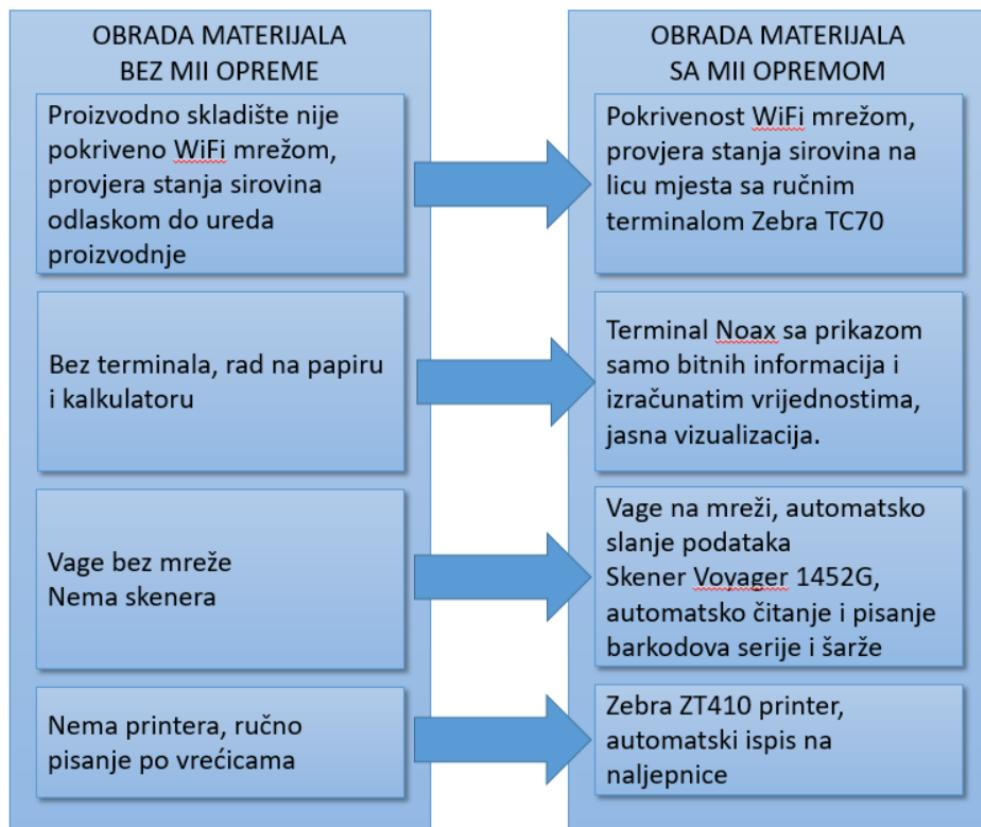
Slika 7.11 Usporedba prije i nakon integracije opreme s procesom obrade materijala<sup>13</sup>
