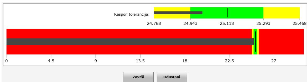
Slika 7.10 Vizualizacija vaganja s ukupnim napretkom i rasponom tolerancija<sup>12</sup>
