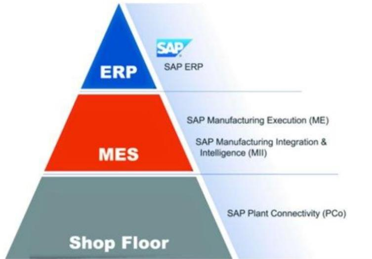
Slika 5.1 Izvršni sustav u odnosu na ERP i proizvodne procese<sup>2</sup>
