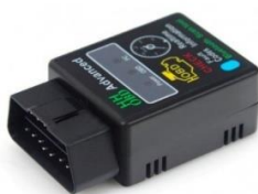
Slika 3.5 Primjer OBD II Bluetooth adaptera
