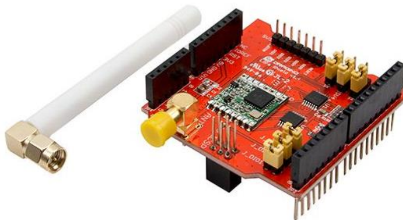
Slika 14 Dragino LoRa Shield v1.4 27
