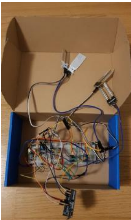
Slika 17. CROduino Basic 2 sa spojenim sensorima
