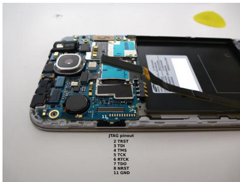
Slika 4.8 JTAG sučelje mobilnog uređaja 20
