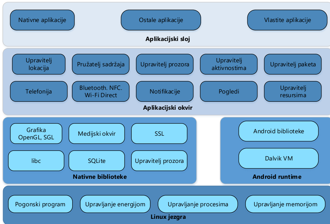
Slika 3.3 Arhitektura Android operacijskog sustava
