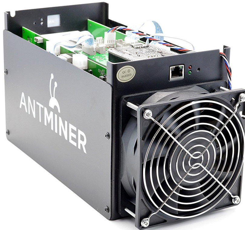
Slika 2.6 ASIC uređaj za rudarenje. Izvor: https://www.amazon.co.uk/Bitmain-AntMiner-S5-1155Gh-Bitcoin/dp/B00RCTIY4G (25.07.2018. u 20:15)
