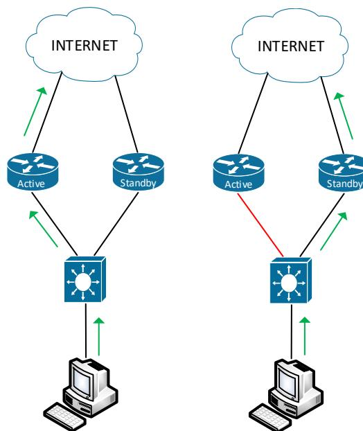
Slika 5.3 HSRP - prikaz toka prometa nakon ispada aktivnog usmjernika<sup>10</sup>
