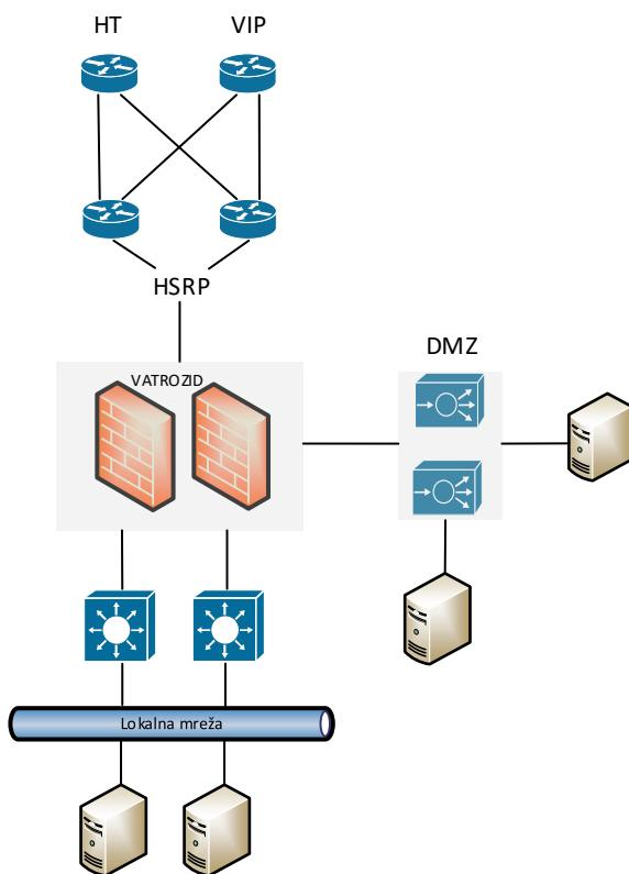
Slika 5.4 Shematski prikaz DR sustava<sup>11</sup>
