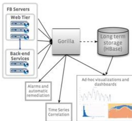
Slika 4.2. Arhitektura Gorilla sustava za praćenje podataka<sup>41</sup>
