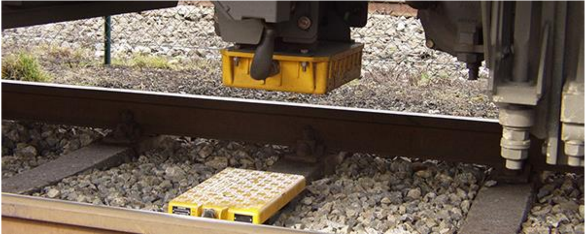
Slika 4 - Eurobalise RFID sustav 17
