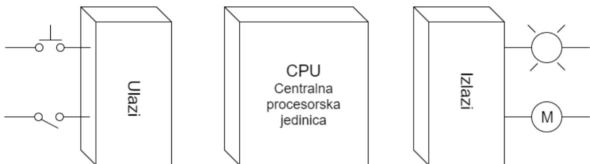
Slika 3.1 Osnovne komponente PLC uređaja<sup>7</sup>
