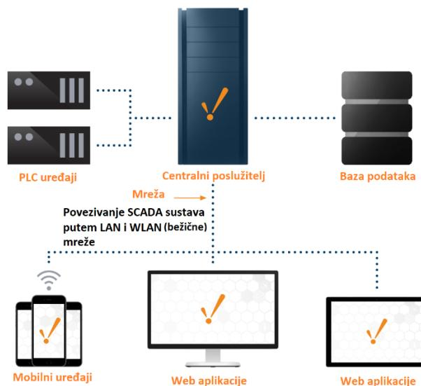
Slika 2.1 Model SCADA sustava<sup>2</sup>
