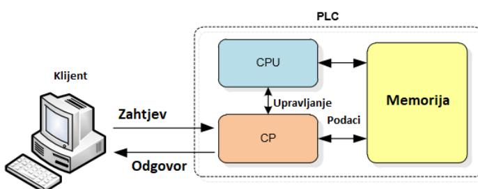
Slika 4.2 Veza računalo klijent i PLC uređaja<sup>24</sup>
