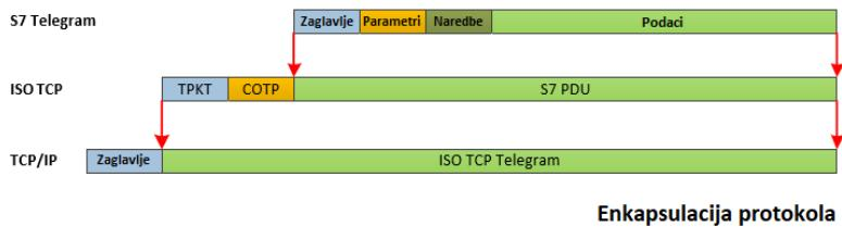
Slika 4.1 Enkapsulacija protokola S7, ISO-TCP, TCP/IP<sup>23</sup>
