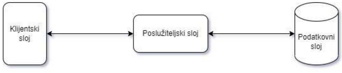
Slika 3.1.1 - Skica arhitekture sustava
