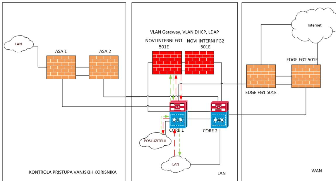
Slika 5.3 VLAN konfiguracija na internom vatrozidu – vlastiti rad
