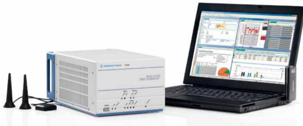
Slika 4.2 Rohde&Schwarz TSMW skener i ROMES mjerna aplikacija [13]
