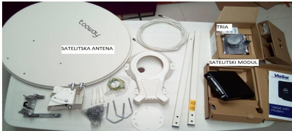
Slika 3.6 Sadržaj opreme u Tooway paketu koja se treba spojiti za povezivanje na KA-SAT satelit
