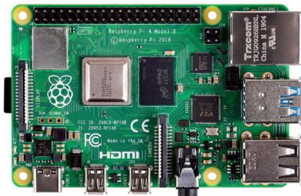
Slika 2.5. Izgled Raspberry Pi, model 4 6
