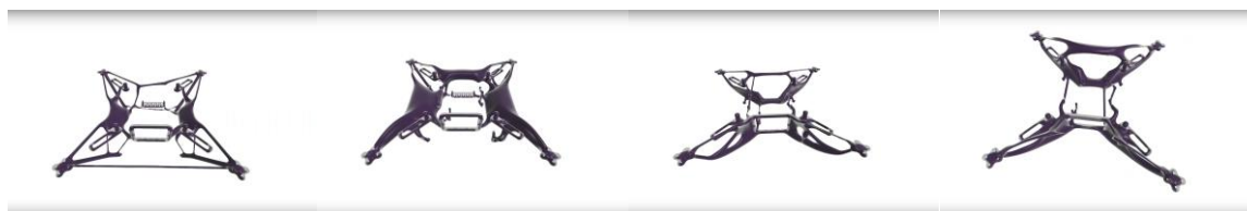
Slika 3.28. AI sustav koji na temelju zadanih preferencija istražuje i modelira prijedloge šasije za dron.
