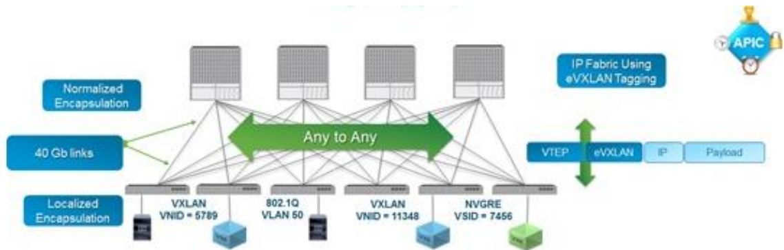
Slika 12 Cisco ACI arhitektura 20
