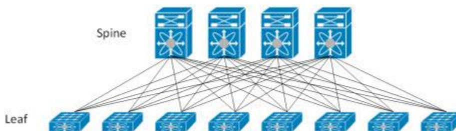
Slika 11 Leaf spine moderna arhitektura preklopnička 19
