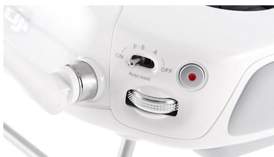
Slika 3.2 Prikaz palice načina rada 10
