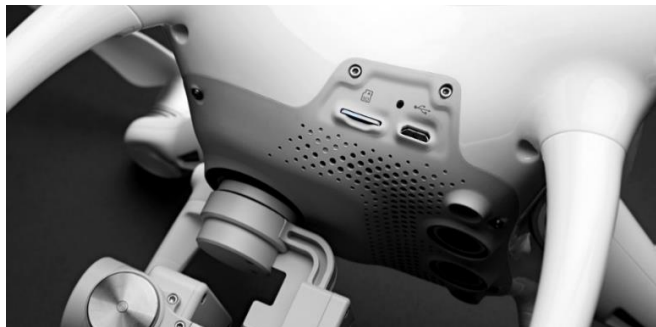
Slika 3.6 Prikaz kamere i SD čitača 16
