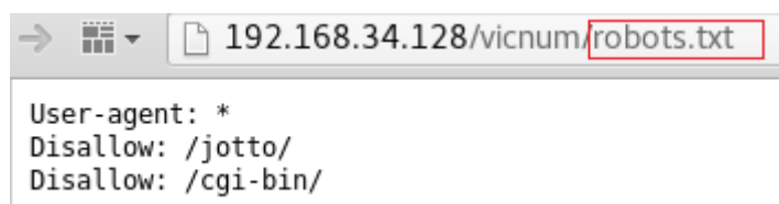
Slika 4.14 Otkrivanje skrivenih direktorija pomoću robots.txt
