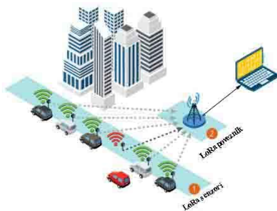
Slika 5.1 Komunikacija pametnog parkirališta korištenjem LoRaWAN tehnologije
