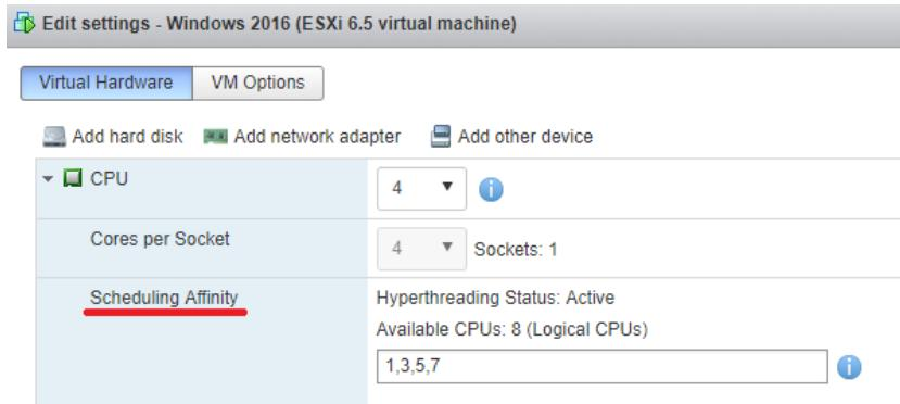
Slika 3.13 Konfiguracija afiniteta raspoređivanja, vlastiti rad autora
