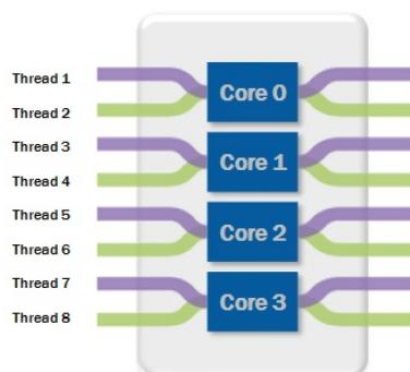
Slika 3.1 Grafički prikaz jezgri korištenog Intel i7 procesora (Ni.com)<sup>11</sup>
